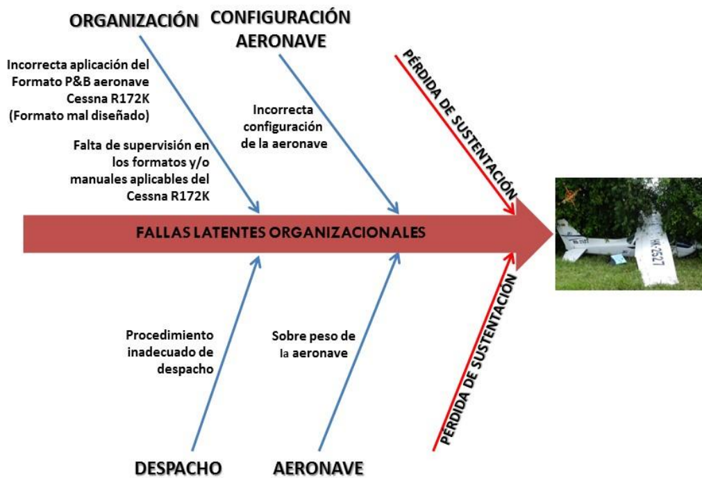
Figura 5. Aplicación del Método “Diagrama de Ishikawa” para el análisis del Accidente
