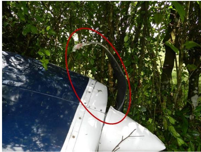
Fotografía 4. Palas con rulo en sus puntas / Aeronave HK-2527
